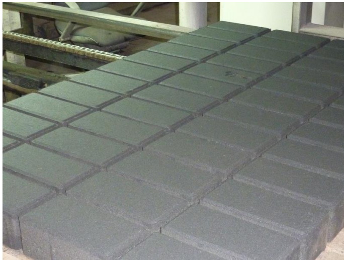
Figuur 2.7 Productie van betonstenen gebruikmakend van de "groene sterkte".
