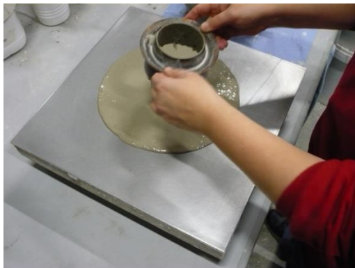
Figuur 2.9 Bepalen van de vloeimaat en trechtertijd van een mortel.
