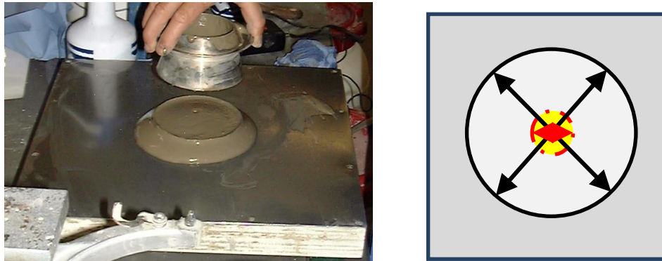
Figuur 2.6 Meten van de vloeimaat van een pasta.
