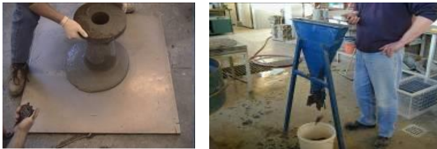
Figuur 2.10 Bepalen van de vloeimaat en trechtertijd van betonspecie.
