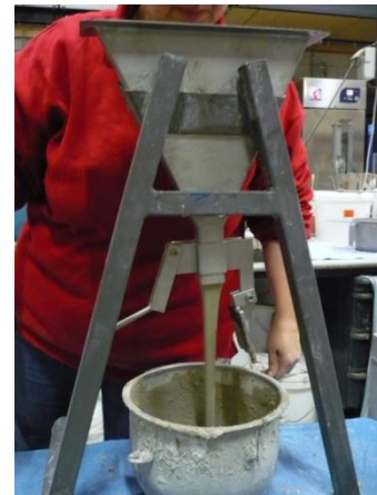
Figuur 2.9 Bepalen van de vloeimaat en trechtertijd van een mortel.
